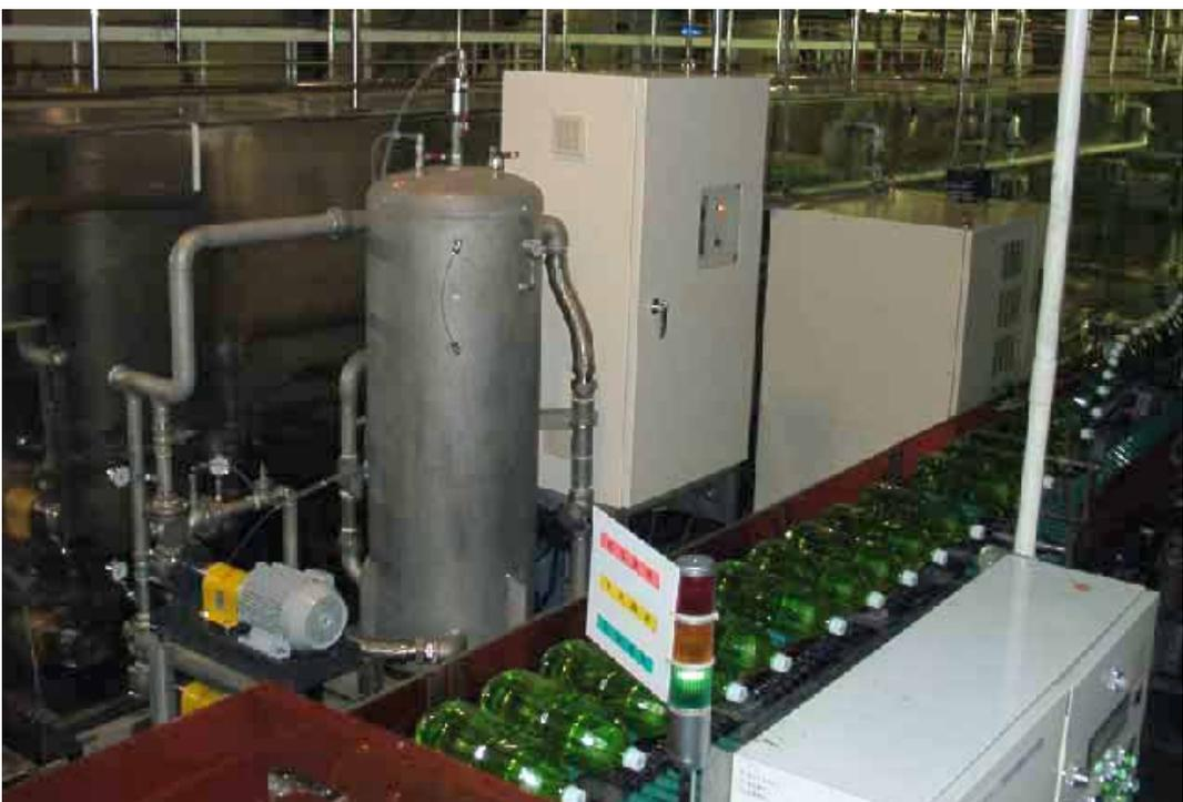
参考:20ton/h・3PPMマイコン制御オゾン水滅菌洗浄システム(ペットボトル洗浄ライン)
