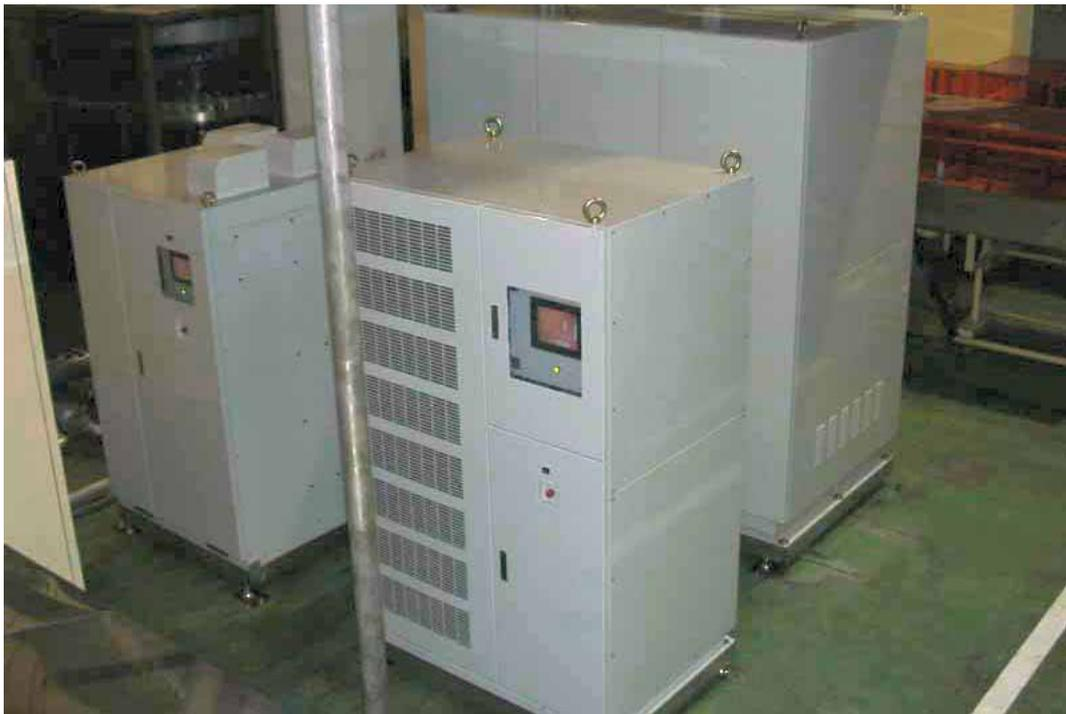
参考:15ton/h・7PPMマイコン制御オゾン水滅菌洗浄システム(ピン洗浄ライン)
